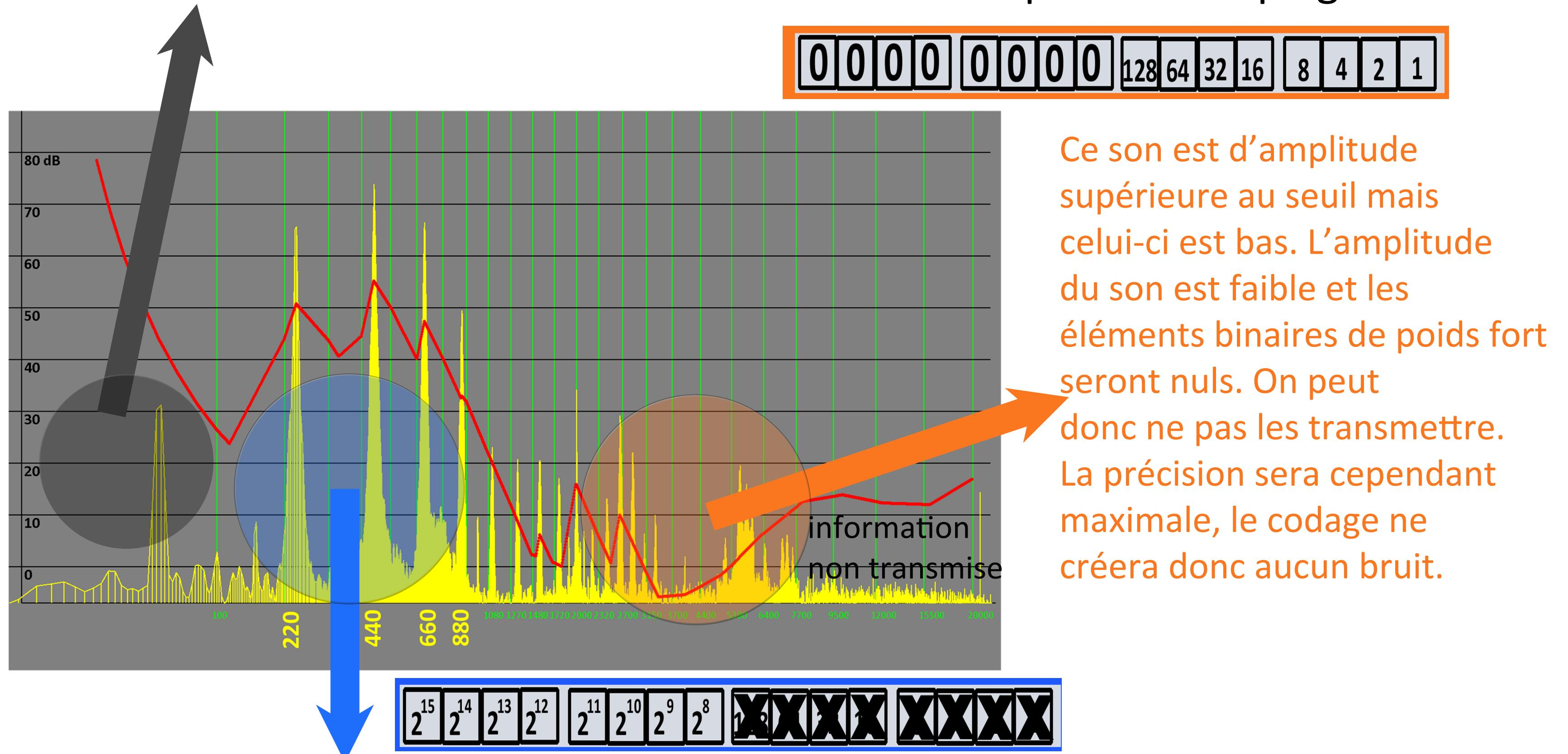
Ce son est d'amplitude supérieure au seuil qui est élevé. Si on la code avec une faible précision, l'erreur commise formera un bruit dont l'amplitude est inférieure au seuil. ce bruit sera inaudible. On peut donc omettre les éléments binaires de poids faible jusqu'à une valeur totale inférieure au niveau du seuil.
