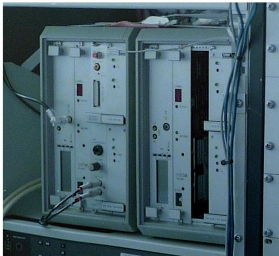
Les technologies mûrissaient dans les laboratoires du CCETT: le COFDM pour la diffusion et le codage du son MUSICAM (développé en partenariat avec l'IRT et Philips pour devenir ensuite le standard ISO Audio MPEG1 Layer 2)
